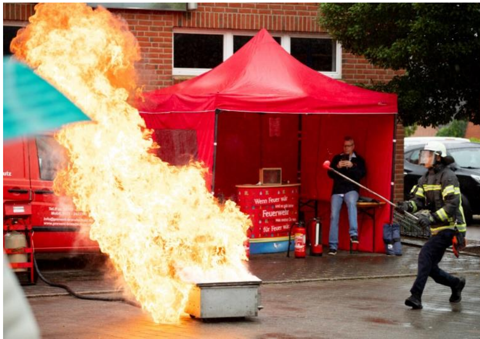
Das passiert, wenn Sie versuchen, einen Fettbrand mit einem Becher Wasser abzulöschen
